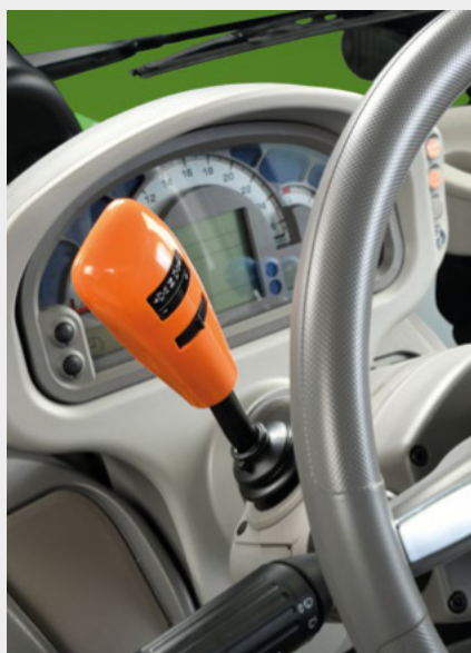
↑ Elektrohydraulický reverzor pojezdu PowerShuttle s nastavitelnou odezvou.
