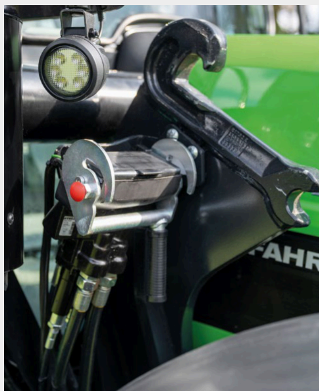
↑ Pevný rám čelního nakladače s připojením Hydro-Fix.
