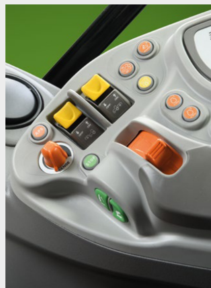
↑ Přední a zadní PTO elektrohydraulicky ovládané a funkce AUTO PTO.
