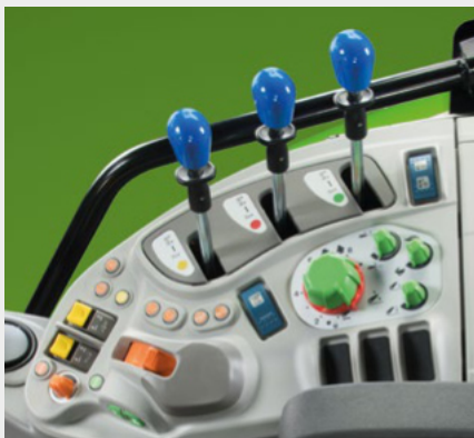
↑ Ergonomické rozložení ovládacích prvků zadního třibodového závěsu a ovládací hydrauliky.
