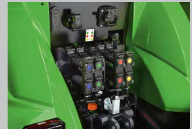
Pět dvojčinných, elektronicky ovládaných hydraulických okruhů pro ovládání a pohon nářadí.
