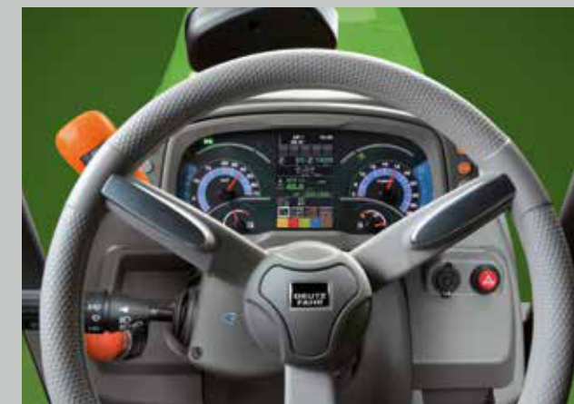
Přístrojová deska poskytuje řidiči analogové a digitální informace o pracovním stavu traktoru v reálném čase.
