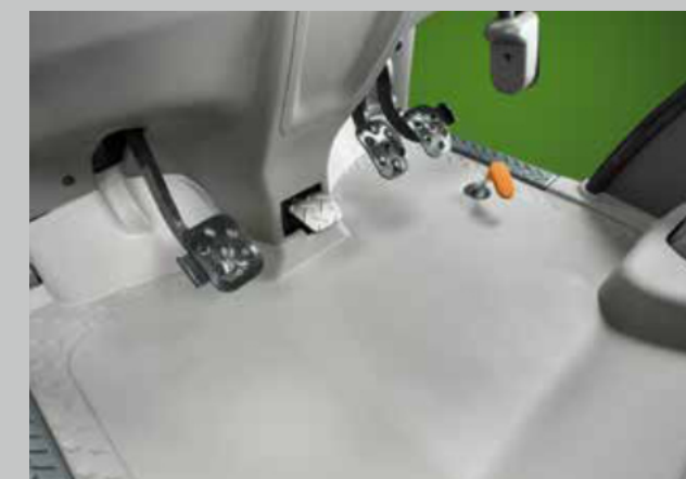
Rovná podlaha kabiny přináší celkově více místa, více prostoru pro nohy a optimální umístění nohou na pedály při sezení.
