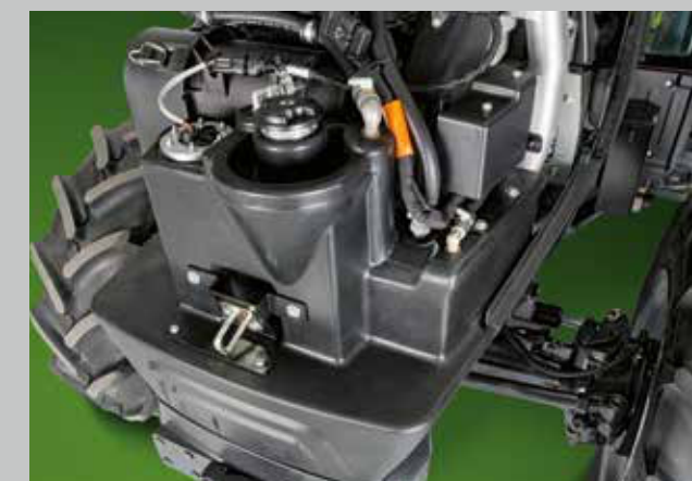
Palivová nádrž je integrována do bloku přední nápravy a lze ji plnit i při zavřeném kapotě. Druhá přídavná nádrž se nachází pod vozkem.
