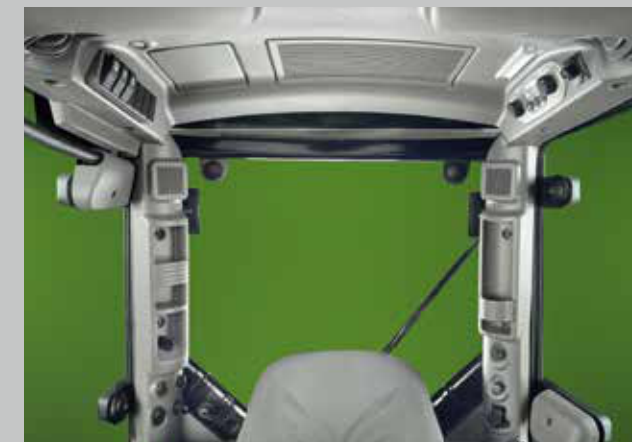
Ovládání klimatizace je snadno dostupné na panelu ve střeše kabiny.
