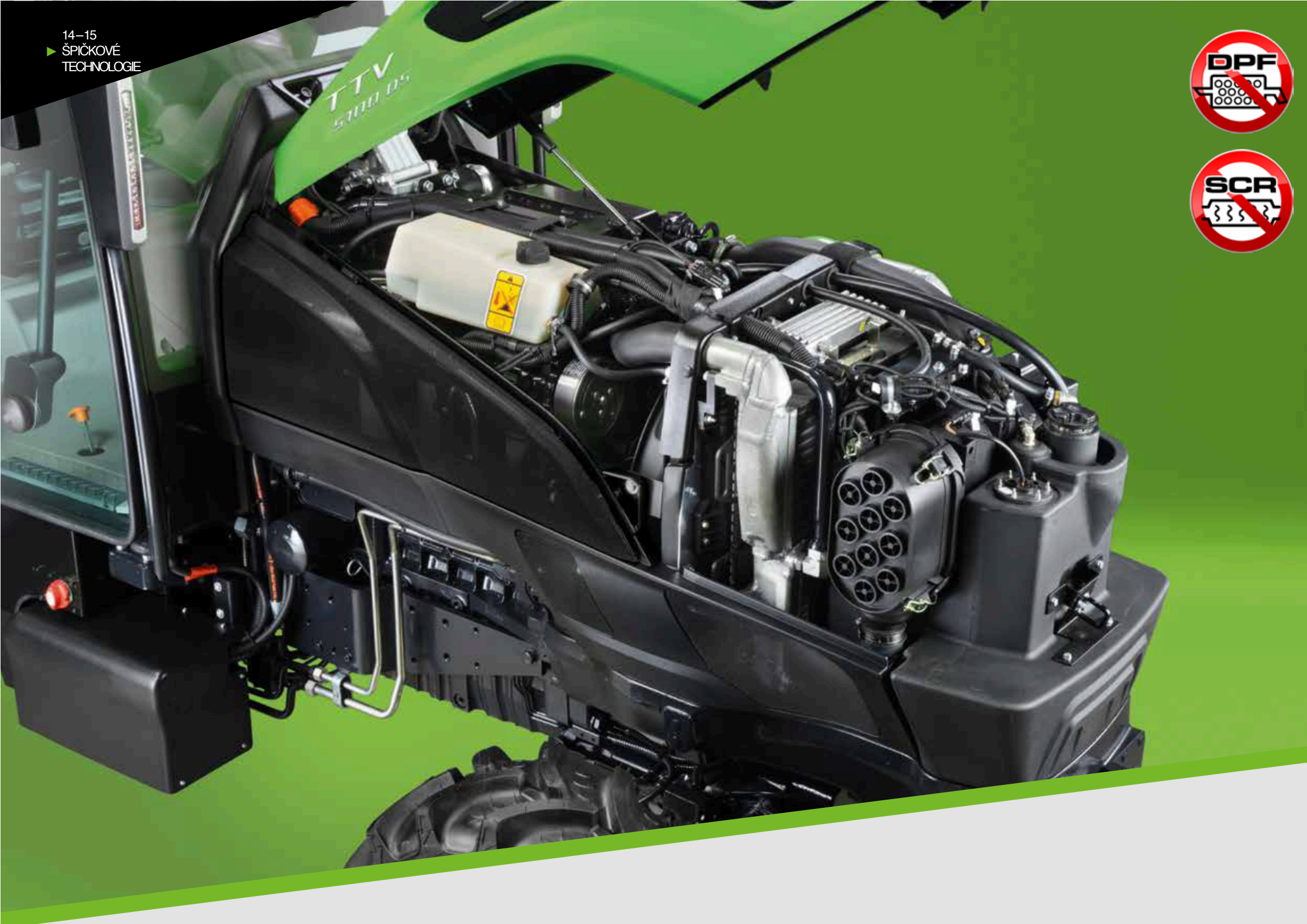
Velký přepracovaný chladicí systém, vylepšené vedení vzduchu a PowerCore vzduchový filtr podporují účinnost motoru.
