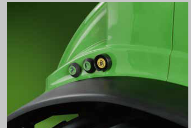
Zadní tříbodový závěs a vývodová hřídel jsou ovládány tlačítky na zadních blatnících.
