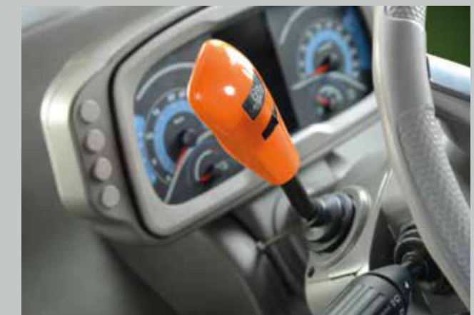
Směr jízdy může být změněn individuálně nastavitelnou PowerShuttle pákou nalevo od volantu.
