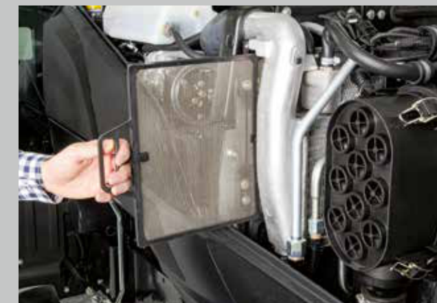
Velký přepracovaný chladicí systém, vylepšené vedení vzduchu a PowerCore vzduchový filtr podporují účinnost motoru.
