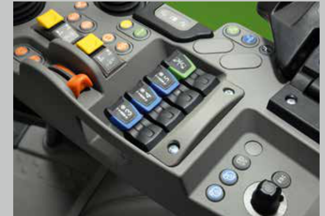
Precizní ovládání přidavných hydraulických okruhů a zadního tříbodového závěsu ergonomicky umístěné přímo na loketní opěrce MaxCom.
