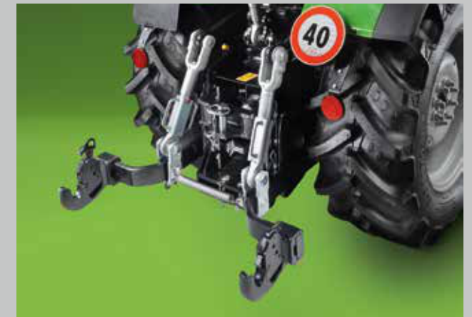
Elektronicky ovládaný zadní tříbodový závěs s maximální kapacitou zdvihu 2.600 kg.
