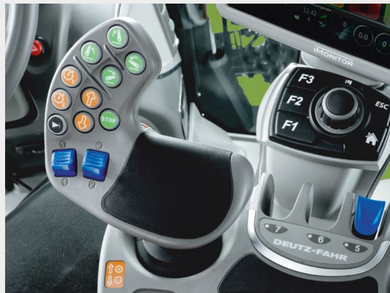
↑ Ergonomický joystick MaxCom s tlačítky třibodového závěsu (TBZ), ovládání motoru a převodovky, s tlačítkem souvratového managementu a s ovládacími prvky dvou proporčních hydraulických okruhů.
