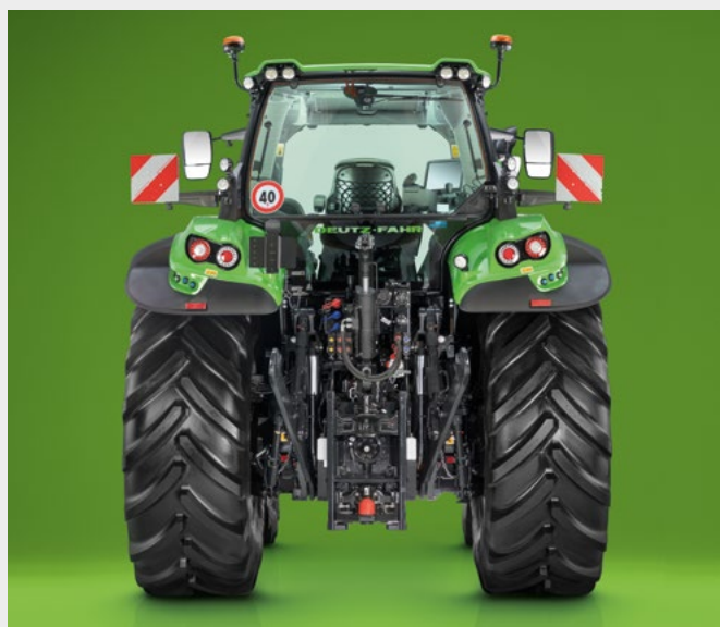
↑ Systém Clean Oil dodává do nářadí až 90 litrů oleje a zajišťuje nejnižší náklady na údržbu díky intervalům výměny 2.000 mth nebo 2 roky.
