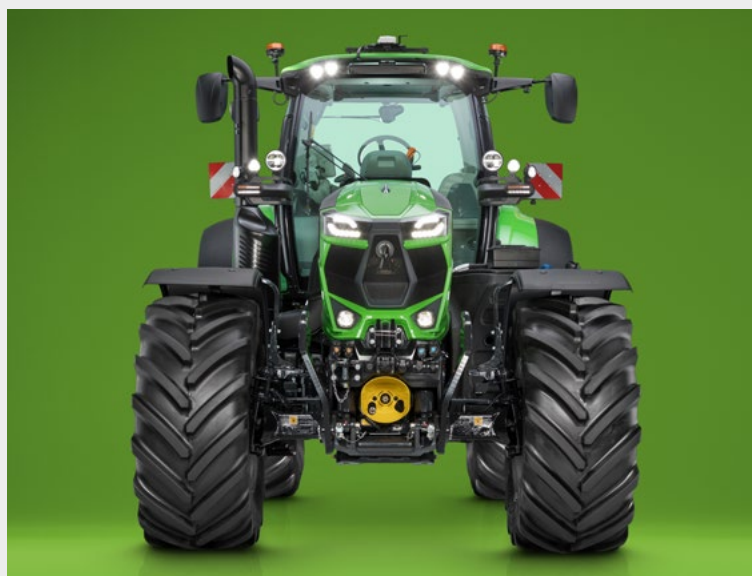
↑ Přední vývodová hřídel DualSpeed nabízí odnímatelnou drážkovanou koncovku, což umožňuje spojení traktoru a nářadí s hnacími hřídelemi libovolného typu.
