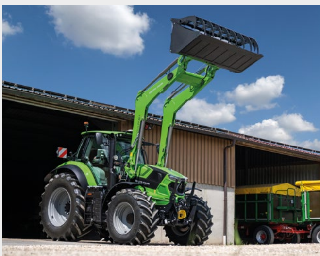
↑ Maximální výška zdvihu 4,5 m a vylamovací síla 37,7 kN.
