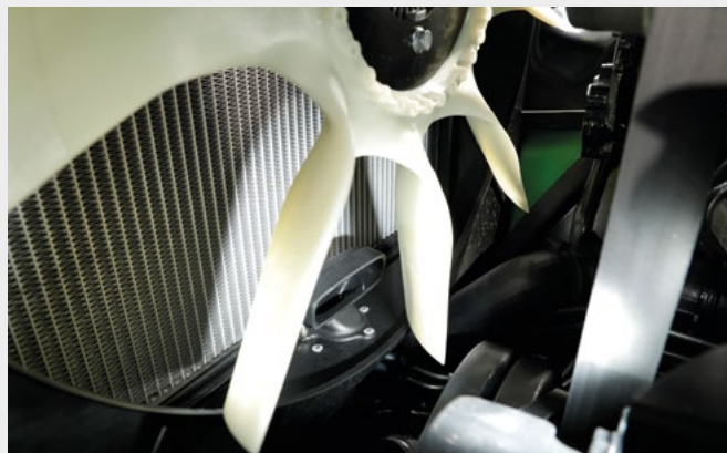
↑ Elektronický viskózní ventilátor (eVisco) se sací hadicí pro systém předčištění vzduchového filtru (odstraňuje 95 % hrubých částic dřívě, než se dostanou k filtrům)..
