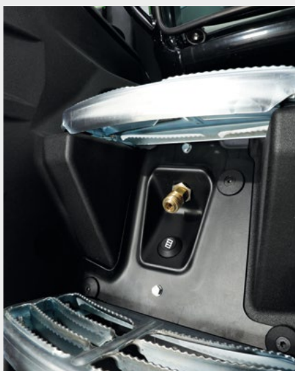
↑ Vývod stlačeného vzduchu a vypínač vstupního světla chrání schůdky.
