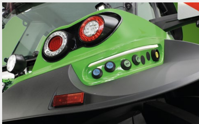
↑ Podsvícená tlačítka pro vnější ovládání zadního TBZ, PTO a hydraulického okruhu.
