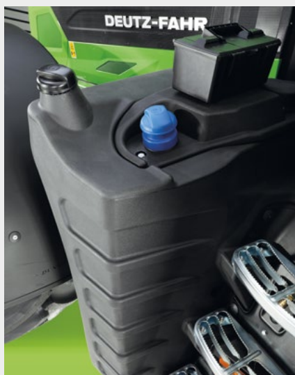
↑ Palivová nádrž o objemu až 505 l pro co nejdelší provoz.
