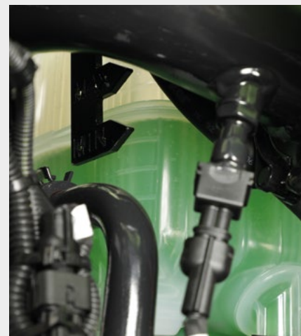
↑ Nádrž na vodu s ocelovými ukazateli hladiny.
