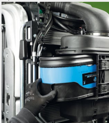
↑ Vzduchový filtr s předčisticí jednotkou.
