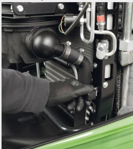
↑ Soubor chladičů s lehce přístupným otevíracím mechanismem.
