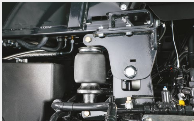
↑ Měchy komfortního vzduchového odpružení kabiny.
